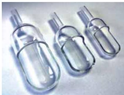
Prodotte in vetro Borosilicato 3.3 di alta qualità. Ideali per polveri e granuli, dispensati tramite stelo tubolare. Forma a imbuto per espulsione senza perdita del campione di pesata.
