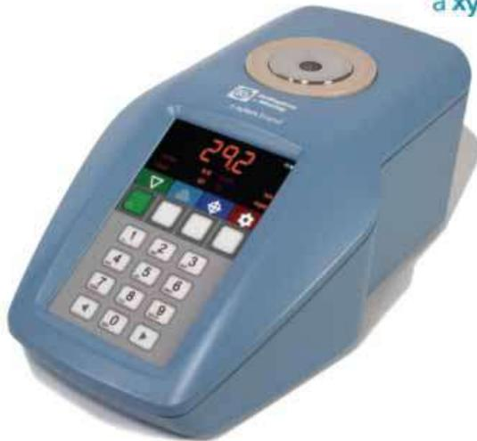
Dispositivo di misurazione robusto e completamente automatico con scala °Brix e compensazione automatica della temperatura fino a 20 °C conforme a ICUMSA per applicazioni impegnative nei settori alimentare, dello zucchero e delle bevande. Il rifrattometro può essere collegato a una stampante o a un PC da laboratorio e produrre risultati di misurazione in formati di stampa standard, CSV o PDF protetti.
