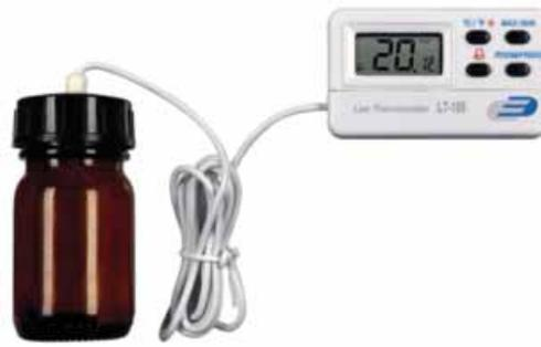
Termometro da laboratorio dalla forma ergonomica con funzione di allarme per il monitoraggio della temperatura.
