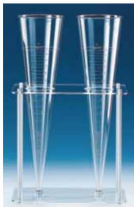
Acilico/PP. Per contenere due coni di sedimentazione Imhoff. Compatto e facile da trasportare anche a pieno carico.
