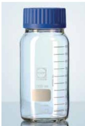
Bottiglia da laboratorio con collo largo GLS 80® (diametro 80 mm), autoclavabile e resistente a temperature fino a 500 °C. Vetro neutro/tipo 1 conforme a USP/EP. Con codice Retrace (identificazione del lotto). Certificato disponibile tramite Internet. Con tappo a vite in PP e anello versatore (autoclavabile e resistente a temperature fino a 140 °C). Con codice di Rintracciabilità (identificazione Lotto). Certificato disponibile online.
