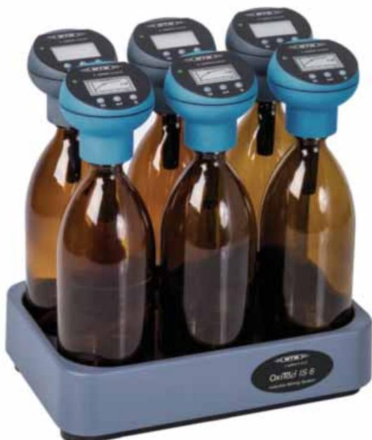
Sistema di misurazione respirometrica di facile utilizzo per determinare la domanda biologica di ossigeno (BOD). La BOD può essere determinata simultaneamente in un massimo di 6 o 12 campioni.
