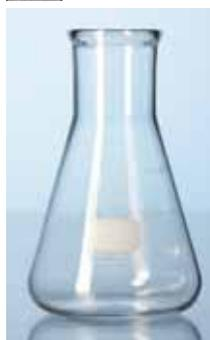
Con graduazioni approssimative. Bordo rinforzato e robusto e maggiore resistenza meccanica per impieghi gravosi. Vetro di tipo I/vetro neutro secondo USP, EP e JP. Con codice di tracciamento (identificazione del lotto). Certificato disponibile tramite Internet. Autoclavabile.
