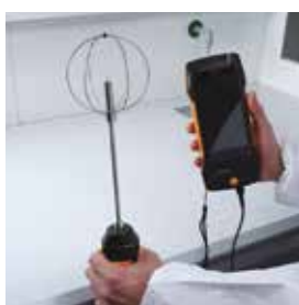
Prove con sonda anemometrica omnidirezionale
