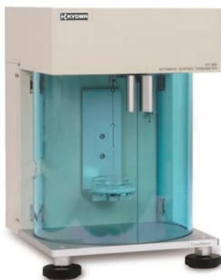
Misurazione della tensione superficiale ed interfacciale dei liquidi. Completamente automatico ed intuitivo.
